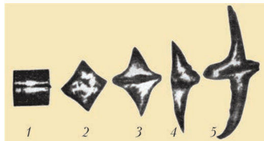
Влияние циклического нагрева, охватывающего два фазовых перехода 668 °C и 775 °C: 1 – исходный образец, 2 – после 50 циклов, 3 – 100 циклов, 4 – 187 циклов, 5 – 250 циклов
